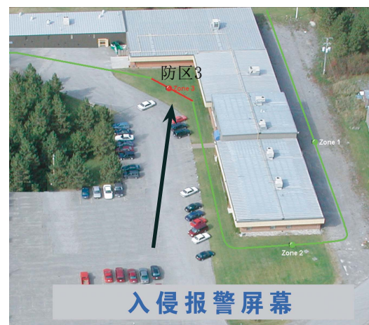
中控室监视器上的StarNeT 1000放大图。周界上防区3中的红色线段正显示报警状态。
